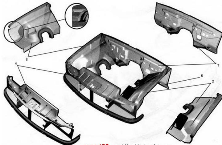
Рис. 111. Каркас оперения (3110-8400024-30)
