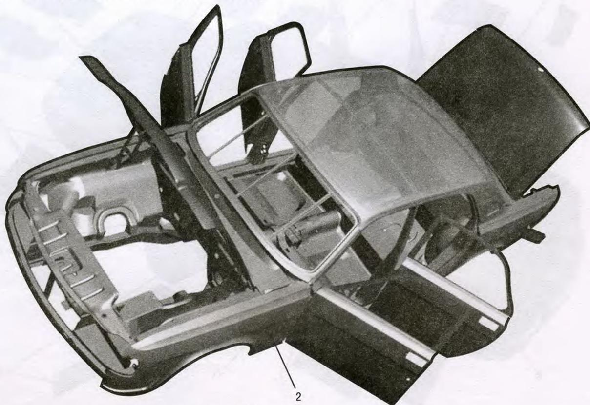
Рис. 11. Кузов (бондеризованный и грунтованный) (3110-5000016-10)
