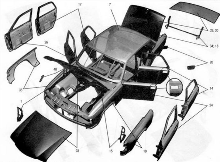
Рис. 29. Кузов (нерихтованный) (3110-500022-201)
