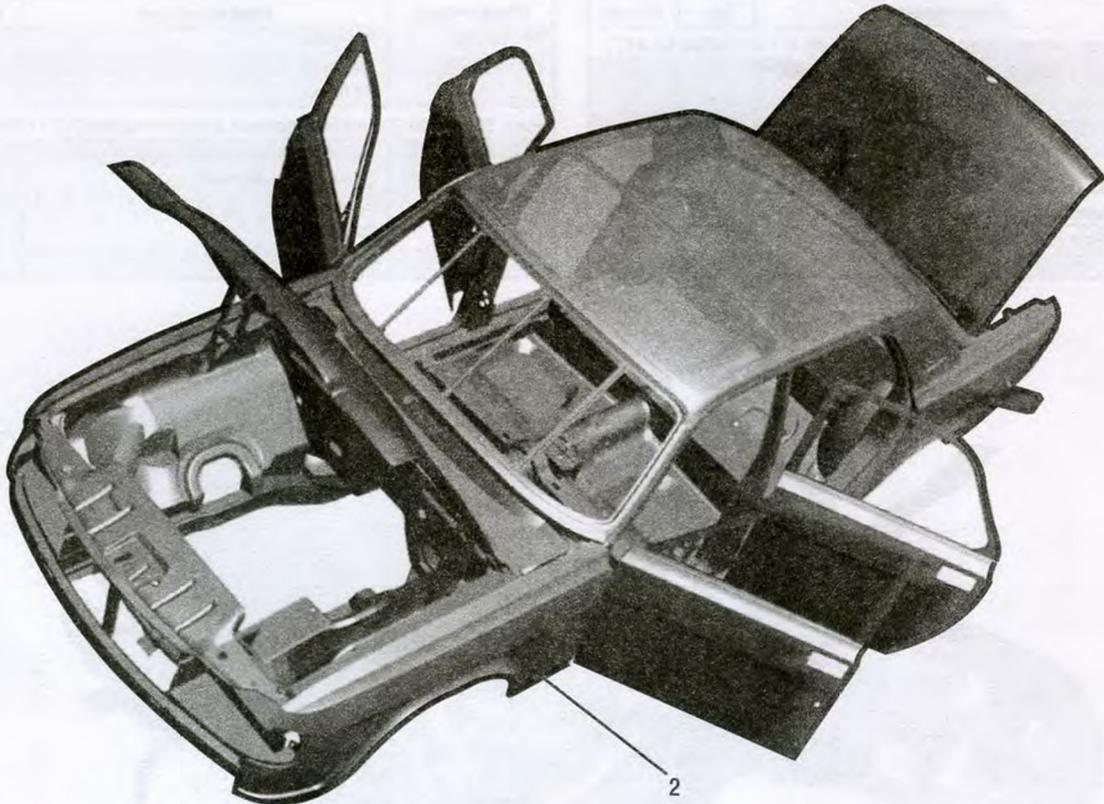
Рис. 12. Кузов (бондеризованный и грунтованный) (3110-5000016-113)
