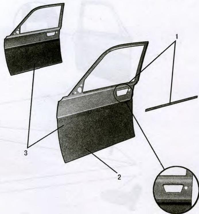
Рис. 94. Панель наружная передней двери левая (3110-6101013-10)
