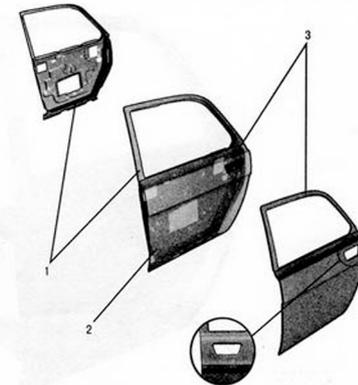
Рис. 98. Дверь задняя левая (сварка) (3110-6200015-10)
