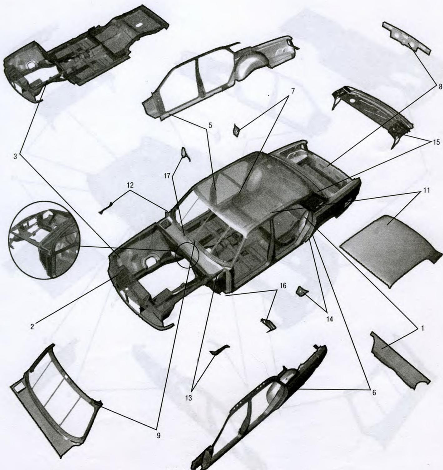
Рис. 32. Кузов (сварка) (31104-5000024)
