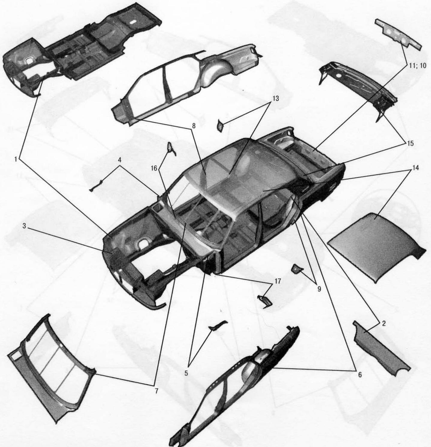
Рис. 33. Кузов (сварка) (3110-500024-10)
