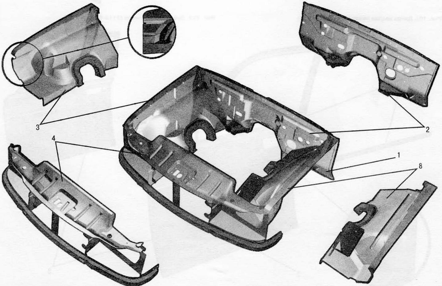
Рис. 106. Каркас оперения (31104-8400024-10)
