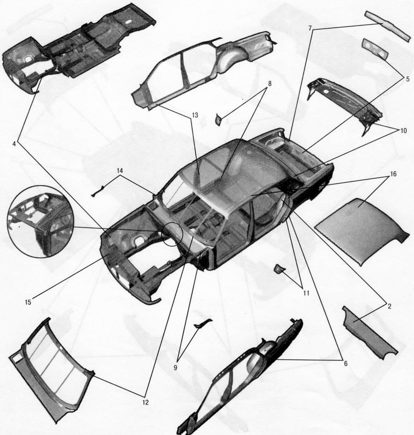
Рис. 39. Кузов (сварка) (31105-5000024-600)
