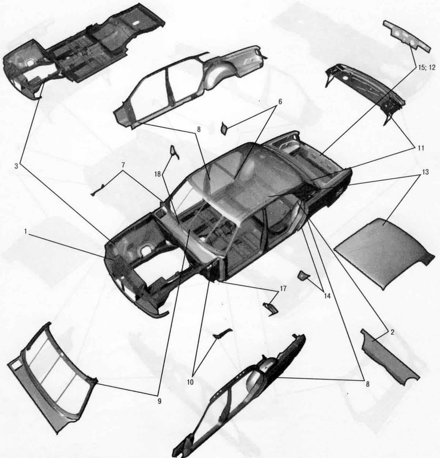
Рис. 34. Кузов (сварка) (3110-5000024-113)
