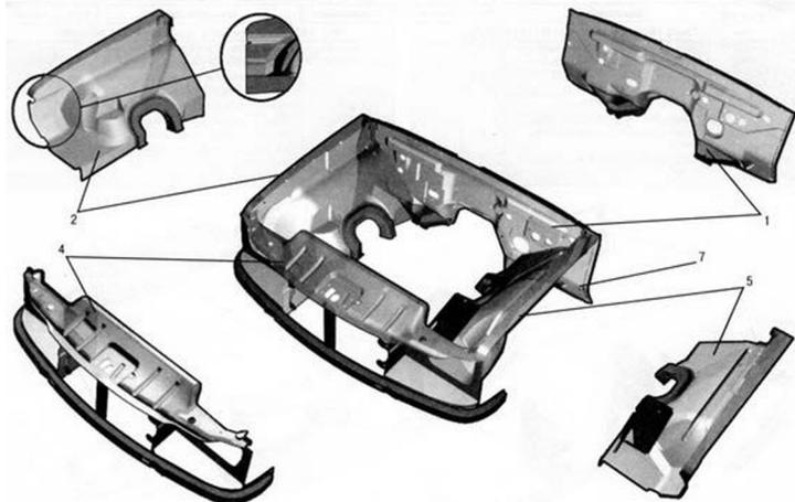
Рис. 110. Каркас оперения (3110-8400024-20)
