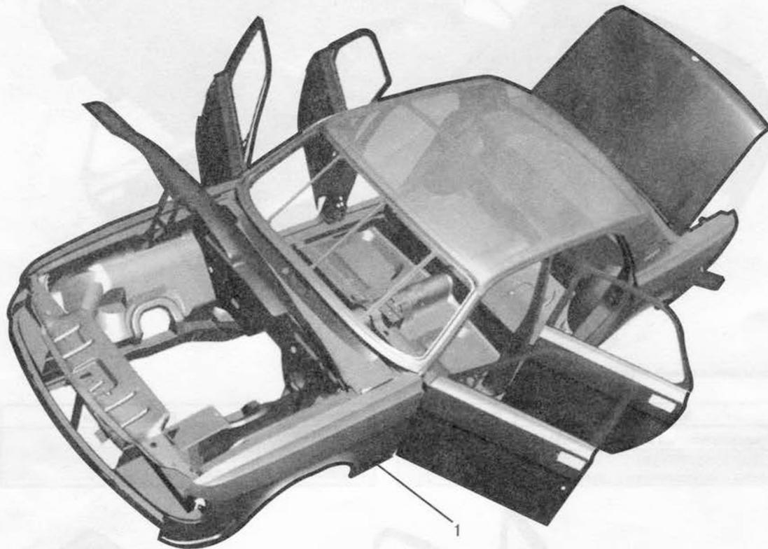
Рис. 14. Кузов (бондеризованный и грунтованный) (3110-5000016-417)
