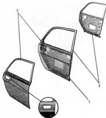
Рис. 95. Дверь задняя правая в сборе (сварка) (31011-6200014)
