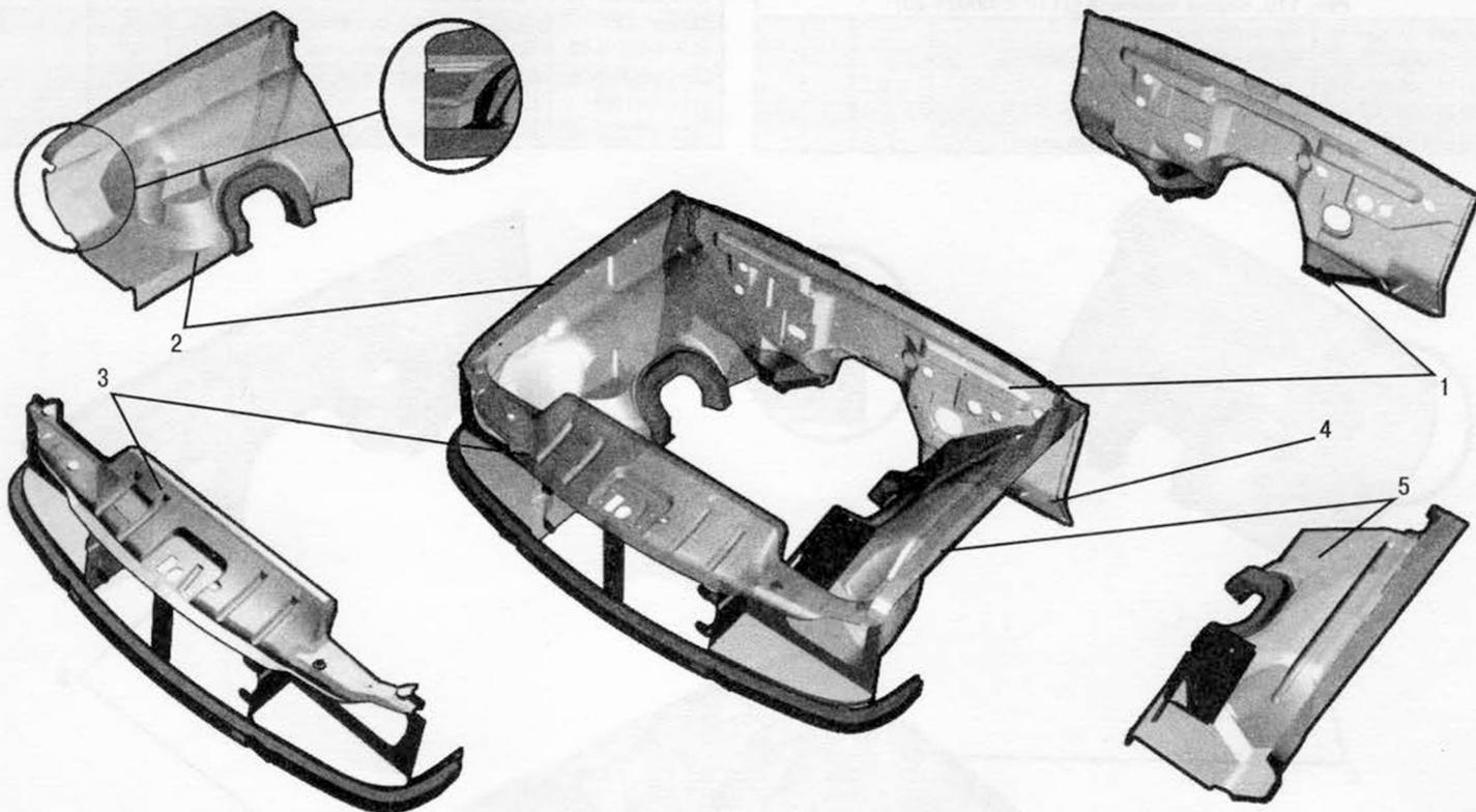
Рис. 107. Каркас оперения (31105-8400024)
