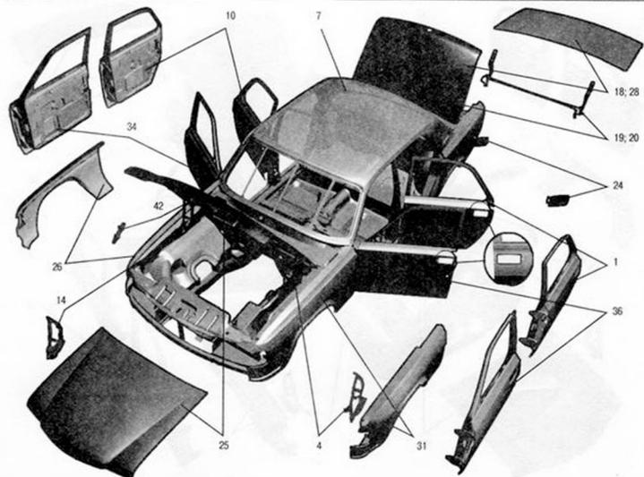
Рис. 28. Кузов (нерихтованный) (3110-500022-113)
