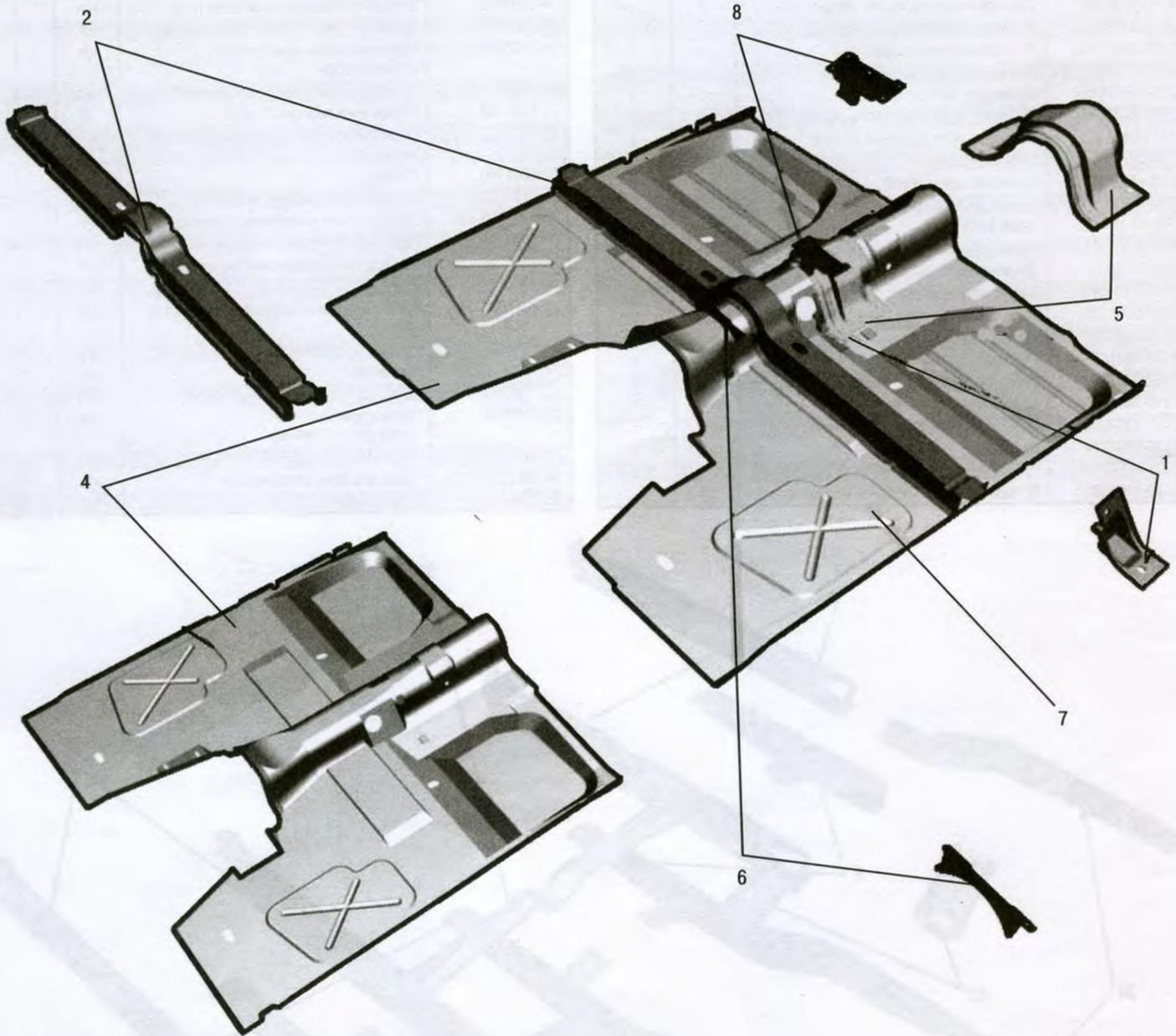
Рис. 49. Панель пола передняя (3110-5101302)
