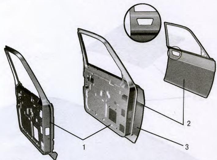
Рис. 87. Дверь передняя левая (сварка) (3110-6100015-20)
