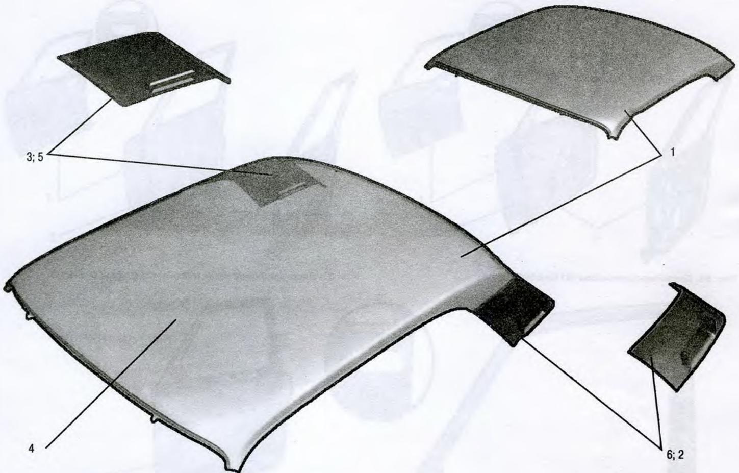
Рис. 83. Панель крыши (3110-5701014)
