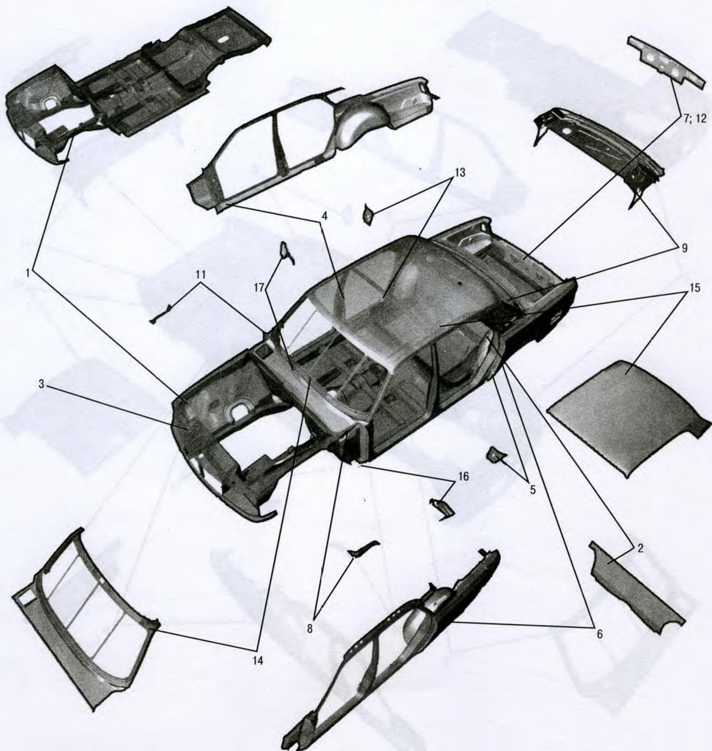
Рис. 35. Кузов (сварка) (3110-5000024-201)
