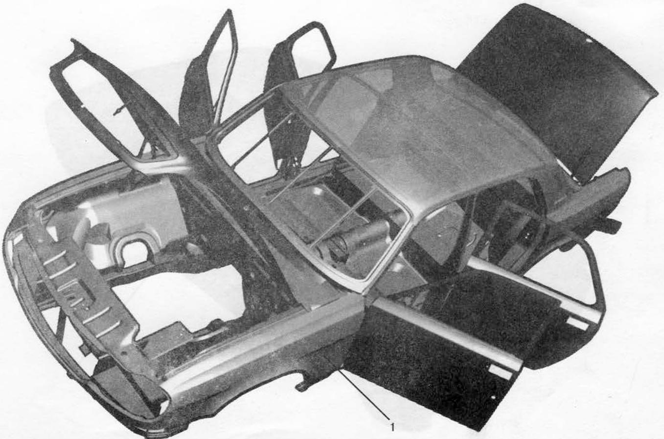
Рис. 17. Кузов (бондеризованный и грунтованный) (31105-5000016-192)
