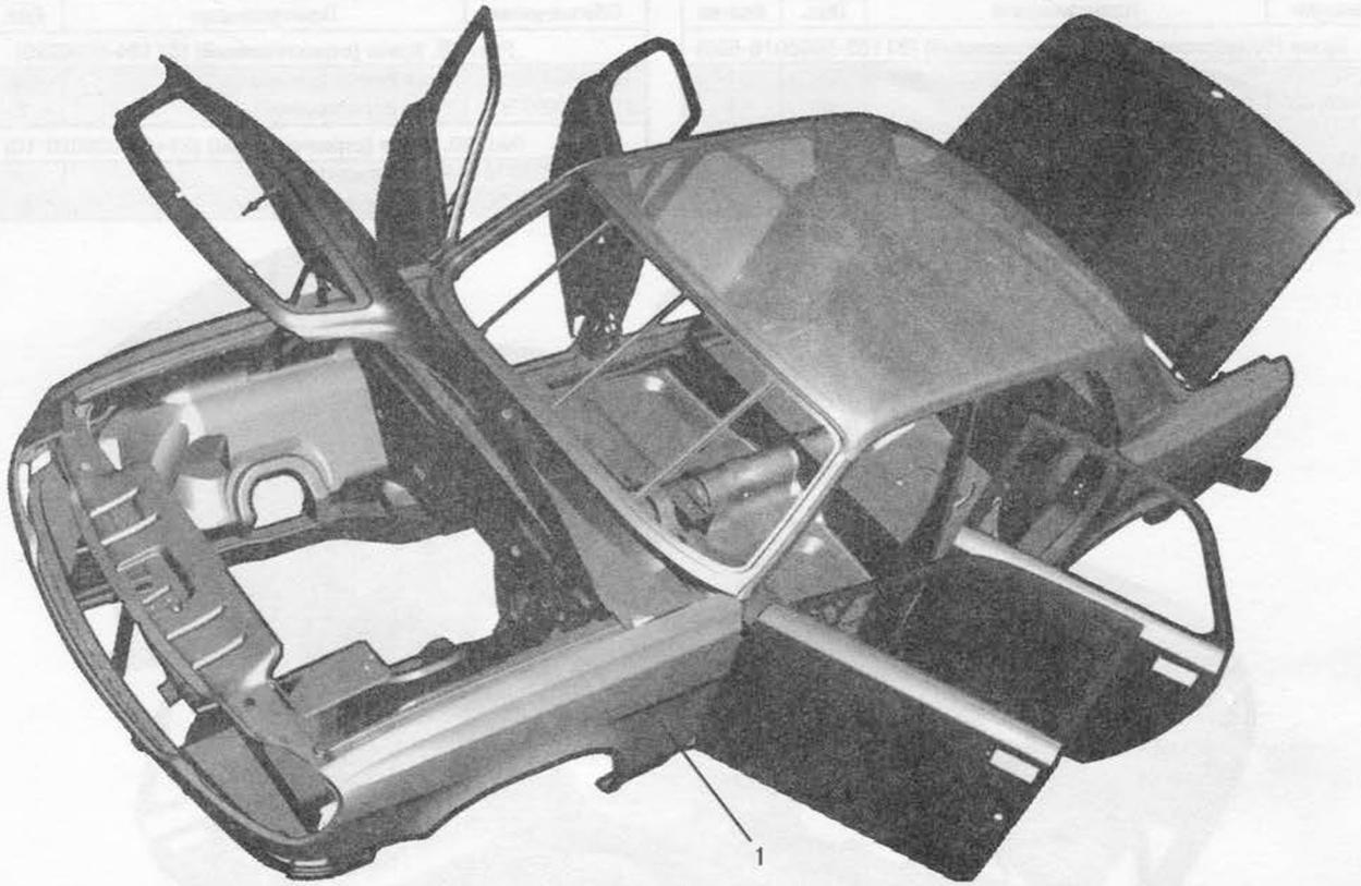
Рис. 16. Кузов (бондеризованный и грунтованный) (31105-5000016-103)
