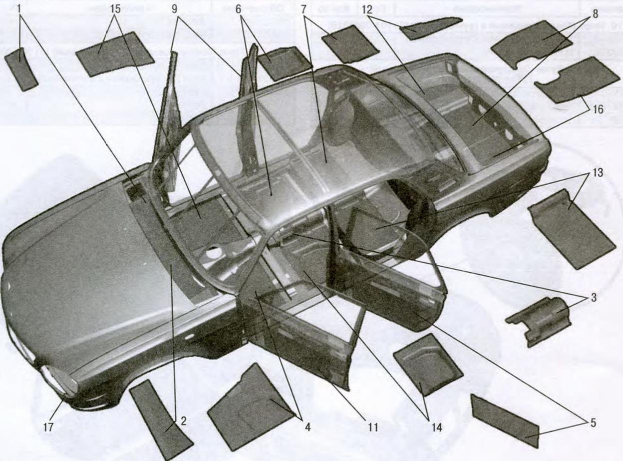
Рис. 8. Кузов (окрашенный) (31105-5000014-192)
