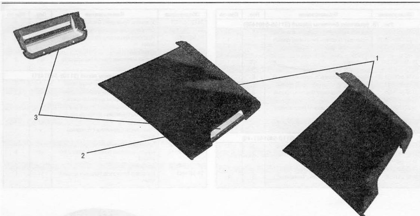
Рис. 76. Панель боковины угловая наружная левая (3110-5401401)
