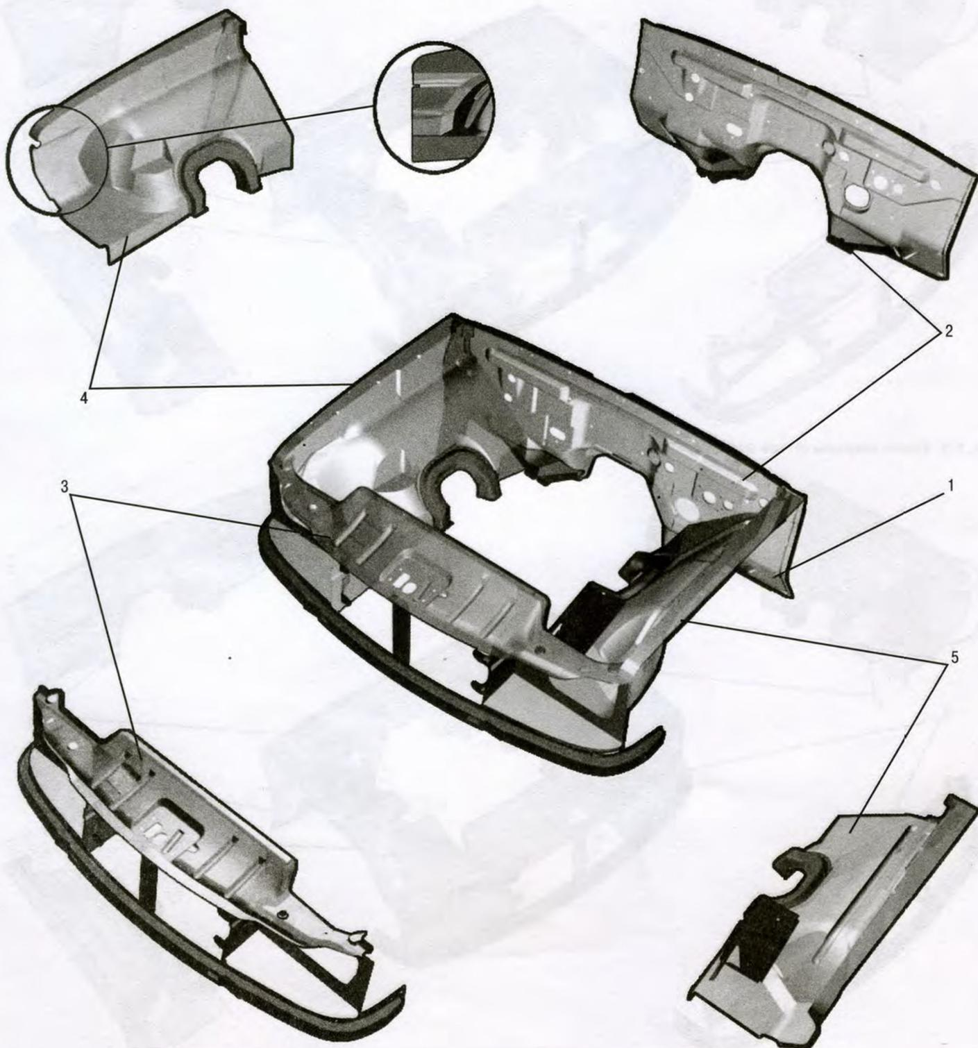
Рис. 109. Каркас оперения (31105-8400024-20)
