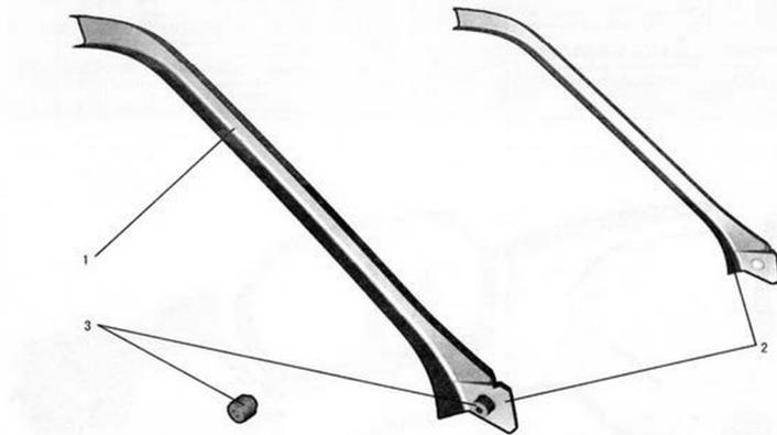
Рис. 74. Вставка передней части боковины левая (24-5401345)
