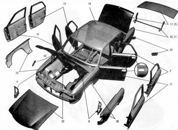
Рис. 30. Кузов (нерихтованный) (3110-5000022-417)
