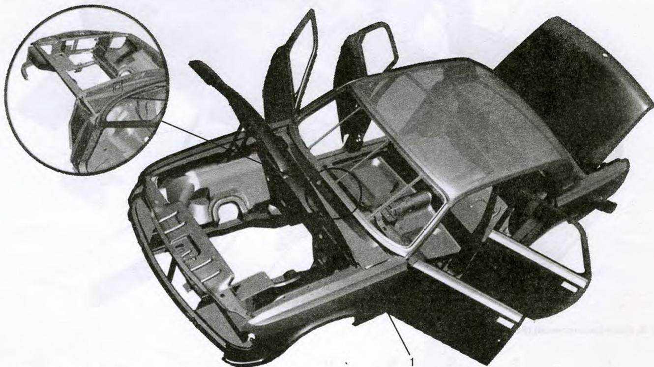
Рис. 10. Кузов (бондеризованный и грунтованный) (31104-5000016)
