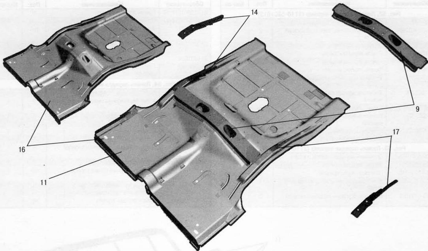
Рис. 50. Панель пола задняя (3110-5101350-10)
