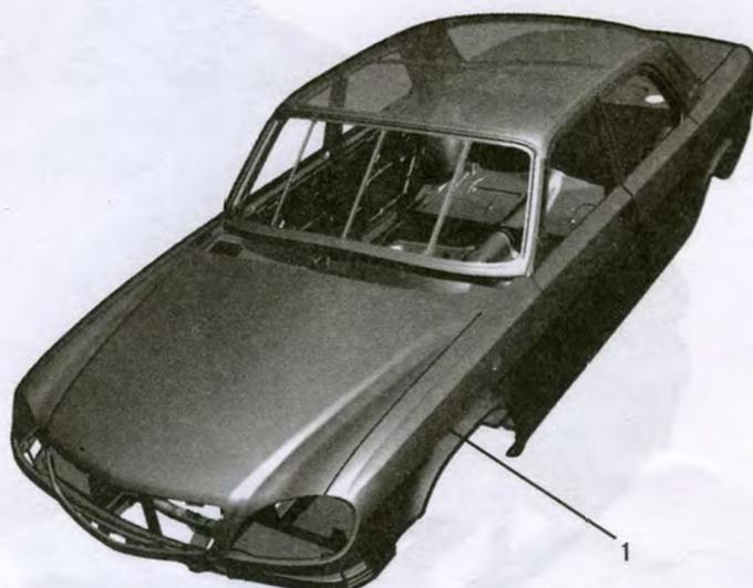
Рис. 24. Кузов (отрихтованный) (31105-5000020-101)
