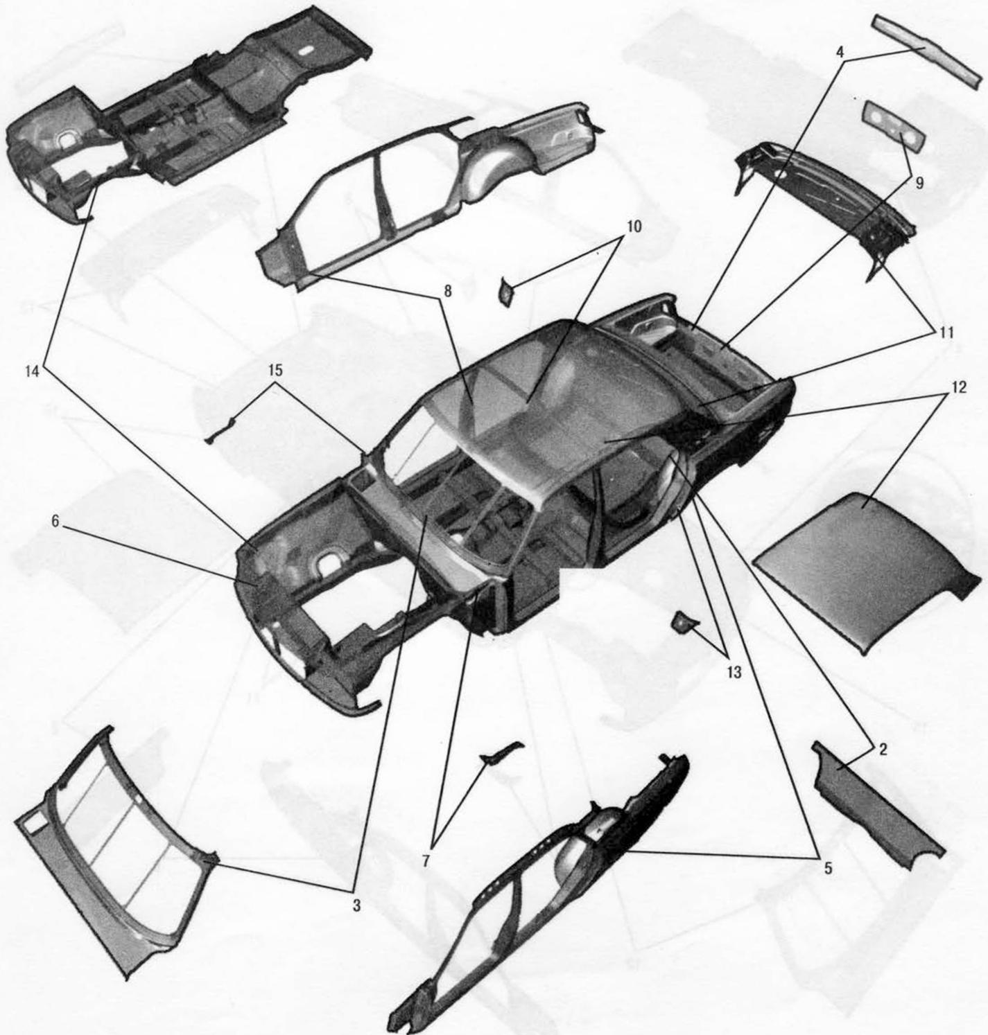
Рис. 38. Кузов (сварка) (31105-500024-103)
