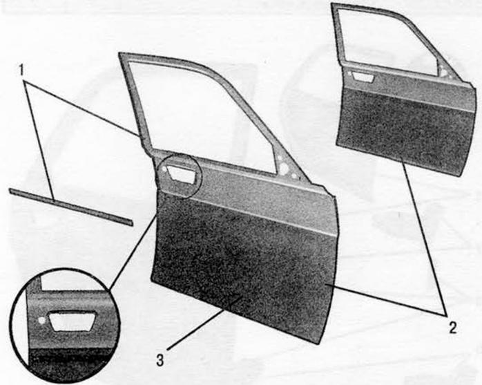
Рис. 105. Панель наружная задней двери левая (3110-6201013-10)
