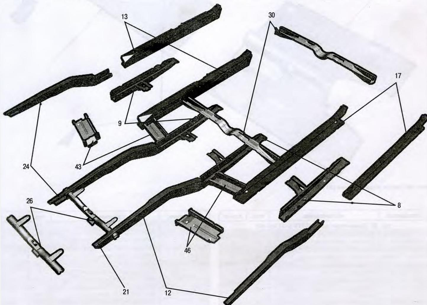
Рис. 48. Каркас пола передний (3110-5101014)
