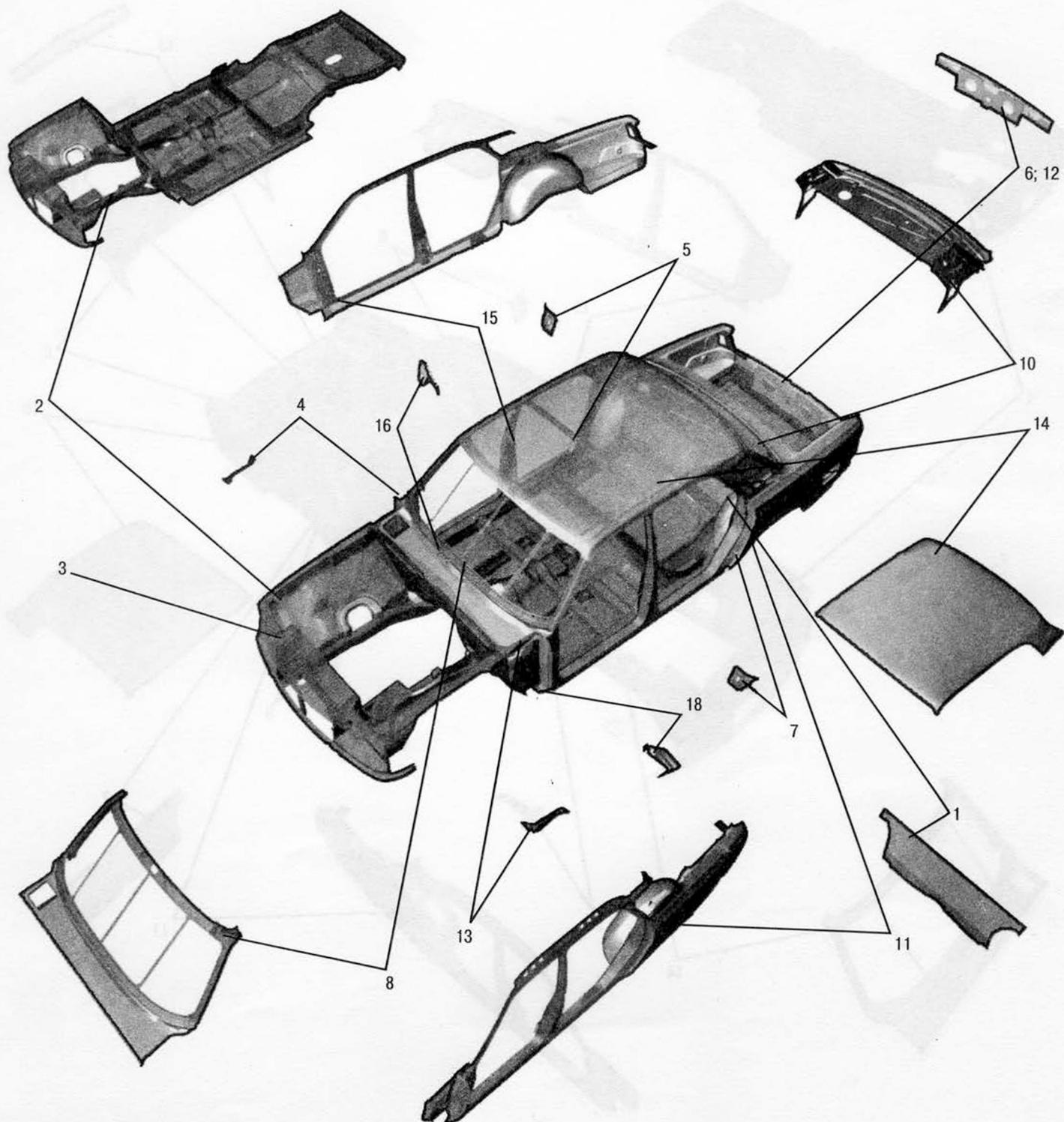
Рис. 36. Кузов (сварка) (3110-5000024-417)
