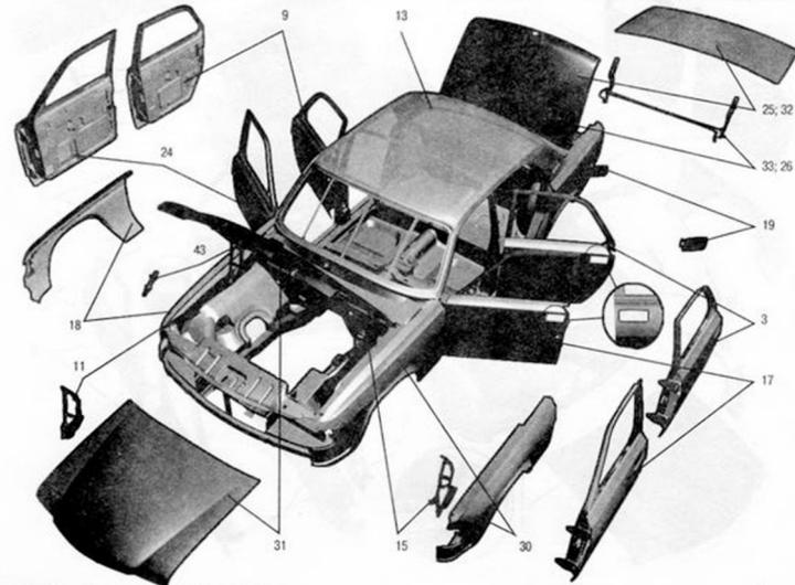
Рис. 27. Кузов (нерихтованный) (3110-500022-10)
