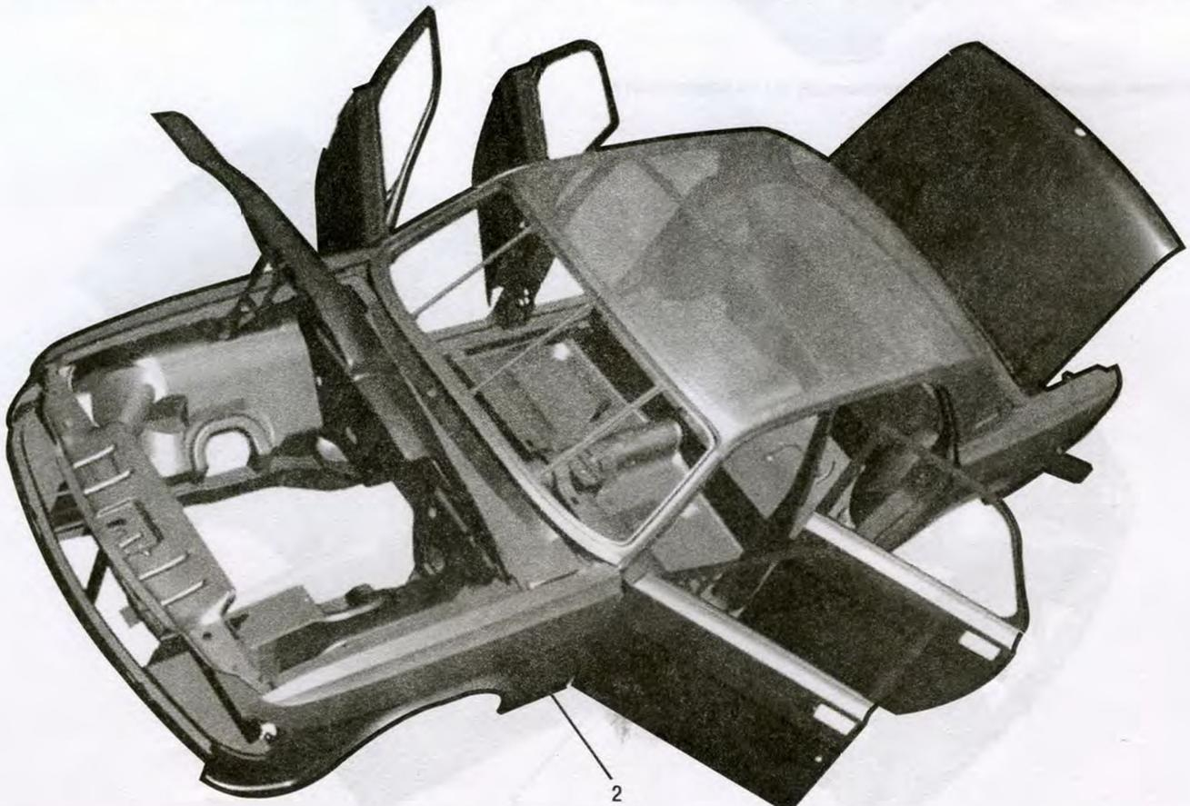
Рис. 13. Кузов (бондеризованный и грунтованный) (3110-5000016-201)
