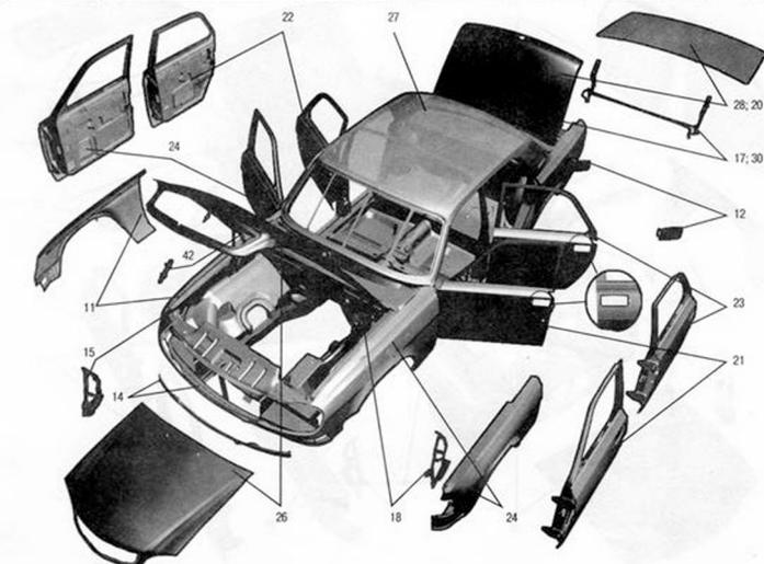
Рис. 31. Кузов (нерихтованный) (31105-5000022-103)
