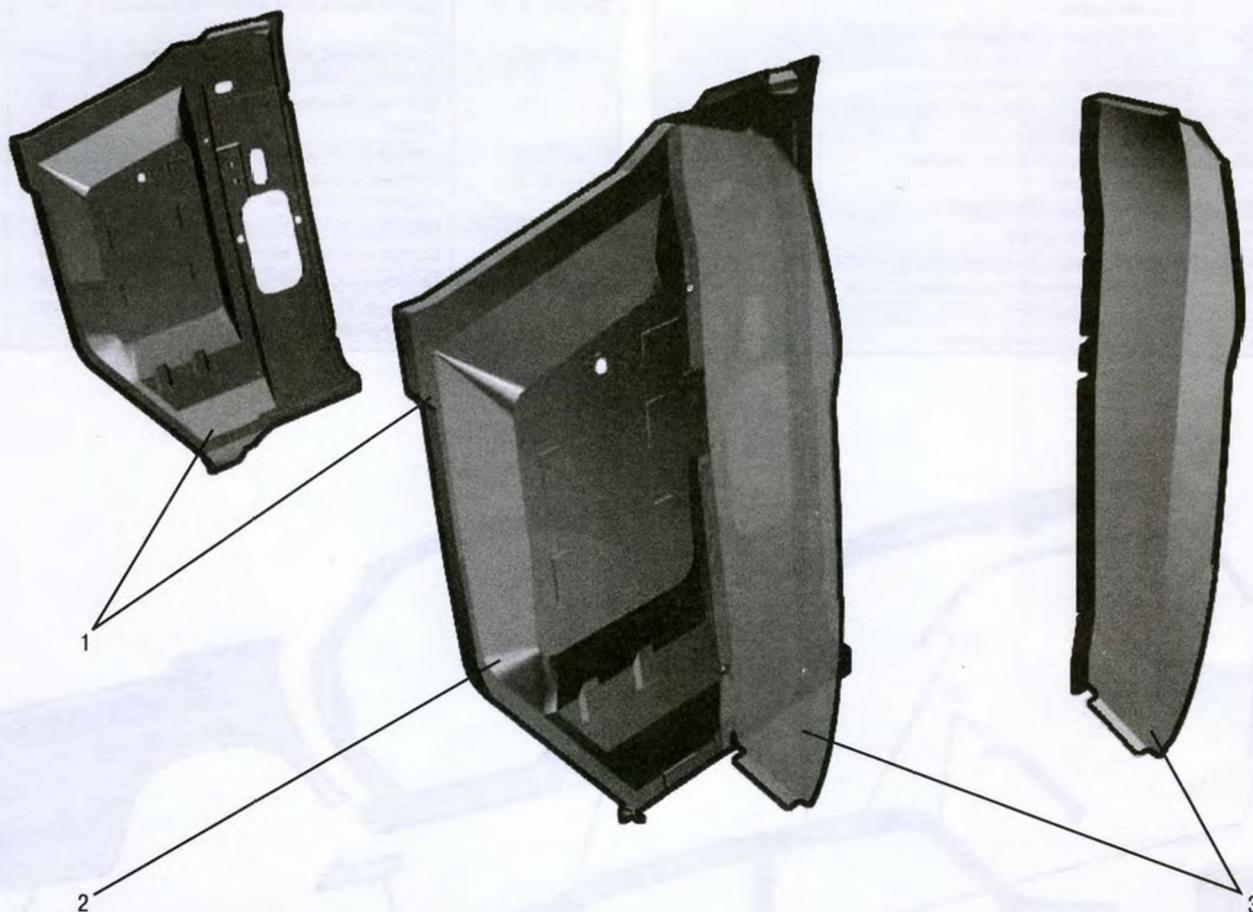
Рис. 63. Панель передка боковая внутренняя левая со стенкой (3110-5301859)
