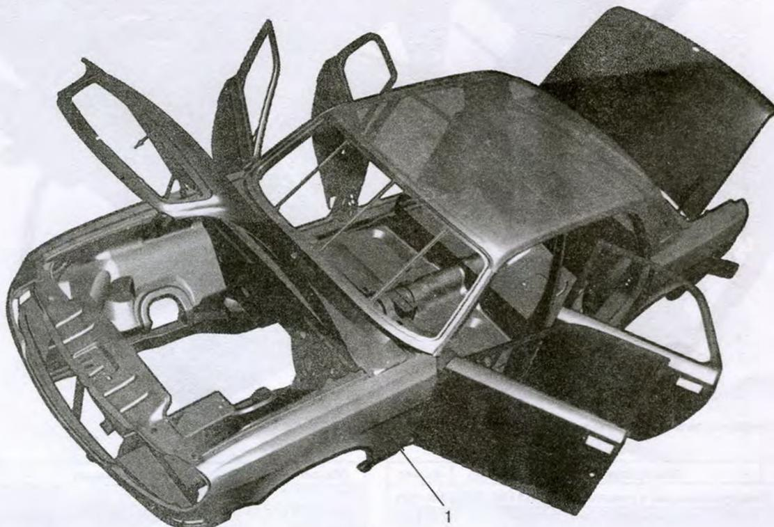
Рис. 18. Кузов (бондеризованный и грунтованный) (31105-5000016-600)
