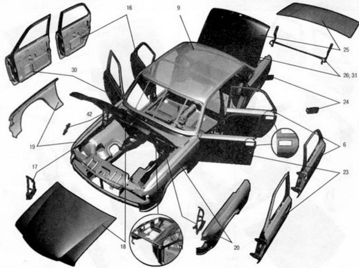
Рис. 26. Кузов (нерихтованный) (31104-5000022)
