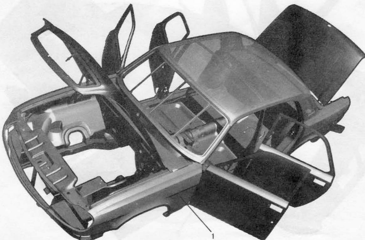
Рис. 15. Кузов (бондеризованный и грунтованный) (31105-5000016-101)
